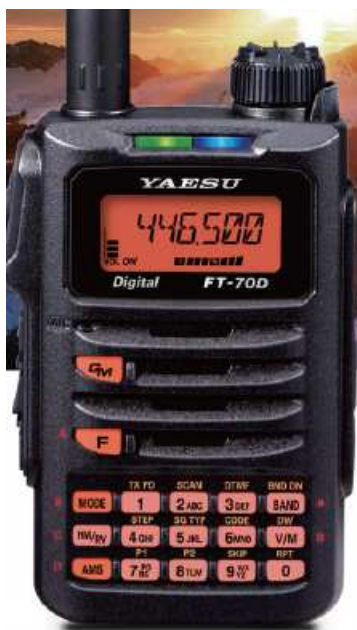
Fot. 2.3. Dwuczęściowe i dwukolorowe wskaźniki odbioru i nadawania na przykładzie FTM-100DE. We wskaźniki tego rodzaju wyposażone są również radiostacje FT-70DE, FTM-3200DE i FTM-3207DE. Przy odbiorze sygnału analogowego oba segmenty świecą na zielono, przy nadawaniu – na czerwono, a w trakcie odbioru lub nadawania emisją C4FM jeden z segmentów świeci na niebiesko
