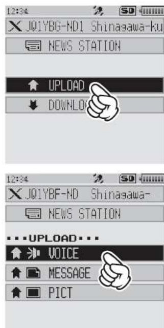
Rys. 3.32. Nadawanie wiadomości głosowych. Po wybraniu w menu wiadomości głosowej należy nacisnąć przycisk nadawania i mówić do mikrofonu, a na zakończenie zaprzestać nadawania
