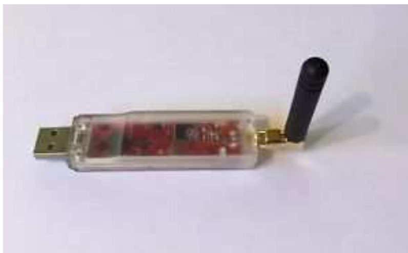
Rys. 2.5 Mikroprzemiennik DV4mini umożliwia pracę w systemach D-Star, DMR, C4FM, APCO P25, dPMR i NEXTEEDGE. W chwili obecnej dostępne jest oprogramowanie sterujące dla Windows i „Maliny”
