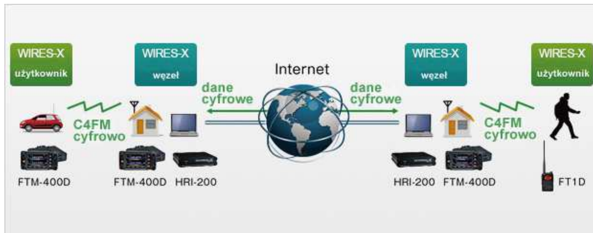
Rys. 3.1. Połączenia przemienników przez WIRES-X
