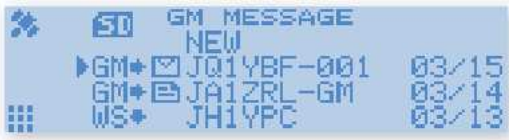
Rys. 5.3. Monitor grupowy na FTM-100DE – spis wiadomości
