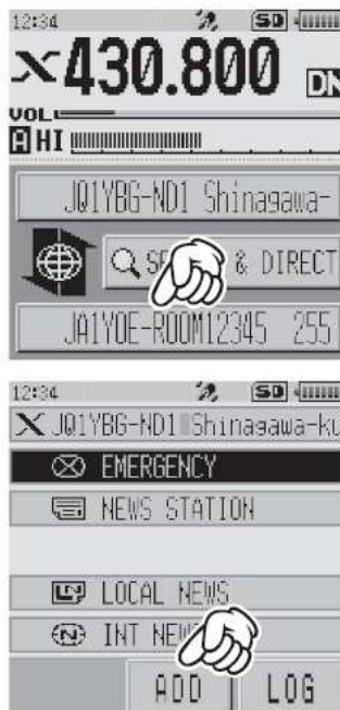
Rys. 3.15. Dodanie celu do jednej z kategorii
