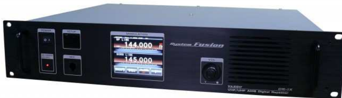
Fot. 2.13. Przeziennik DR-1XE zawiera wewnątrz dwie radiostacje FTM-400DE
