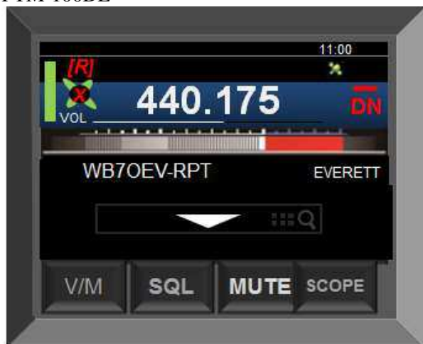
Połączenie z lokalnym węzłem na ekranie FTM/400DE
