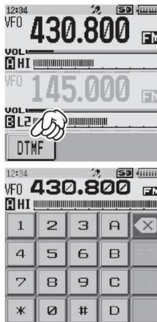
Rys. 3.19. Połączenia za pomocą DTMF przy pracy analogową emisją FM
