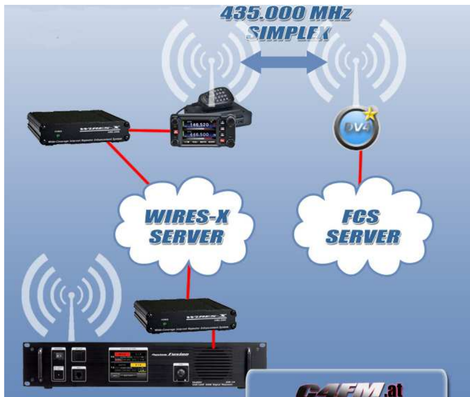
Rys. 4.2. Zasada połączenia sieci WIRES-X z reflektorem FCS za pośrednictwem DV4mini (źródło: C4FM.at). Zamiast kanału simpleksowego można korzystać oczywiście i z półdupleksowego.
