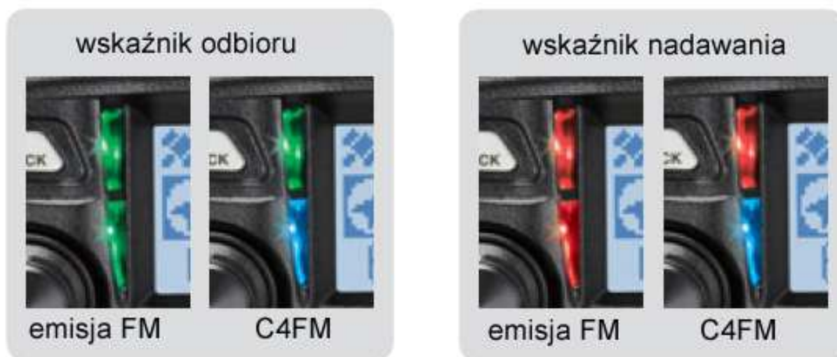
Fot. 2.3. Dwuczęściowe i dwukolorowe wskaźniki odbioru i nadawania na przykładzie FTM-100DE. We wskaźniki tego rodzaju wyposażone są również radiostacje FT-70DE, FTM-3200DE i FTM-3207DE. Przy odbiorze sygnału analogowego oba segmenty świecą na zielono, przy nadawaniu – na czerwono, a w trakcie odbioru lub nadawania emisją C4FM jeden z segmentów świeci na niebiesko
