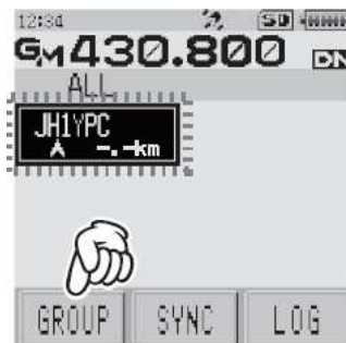
Rys. 5.5. Dopisywanie lokalnego węzła do grupy
