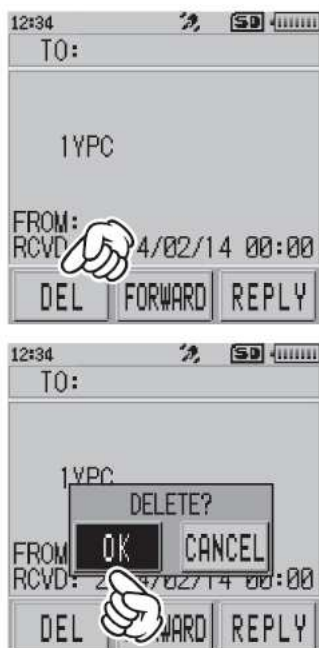
Rys. 3.26. Kasowanie wiadomości po naciśnięciu przycisku „DEL”
