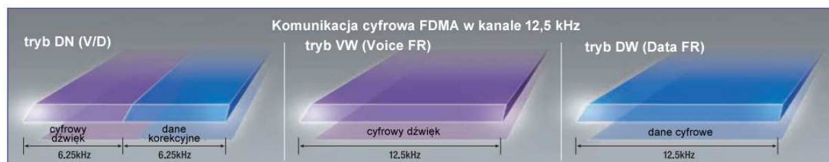
Rys. 1.1. Warianty transmisji w systemie C4FM/FDMA
